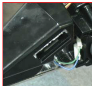
ゴト行為により破損された払出口
