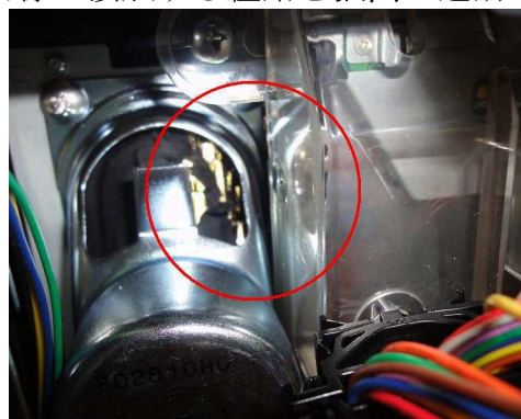
被害台のスピーカー損傷部分
