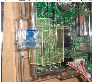
サブ基板内部への器具挿入経路を遮断します
